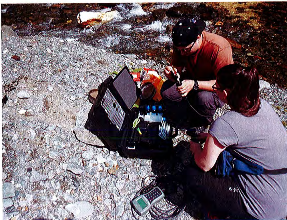
Figura 28. Măsurarea turbidității apei cu ajutorul analizorului portabil multiparametru Hanna 9289
