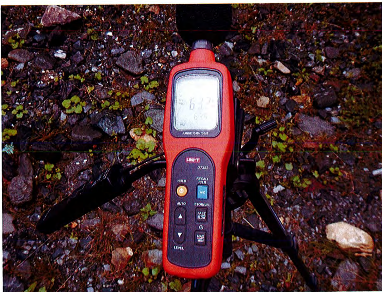
Figura 31. Sonometrul UNI-T model UT350 utilizat pentru măsurarea nivelului de zgomot în zona Dunărea Veche 2
