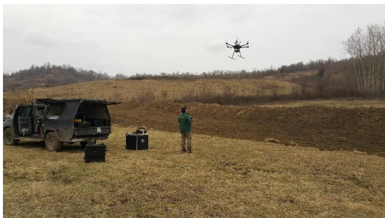
Figura nr. 5. Drona DJI Phantom III-Advanced pregătită de zbor (stânga); Dronă DJI Matrice 600 PRO cu unitate LiDAR
