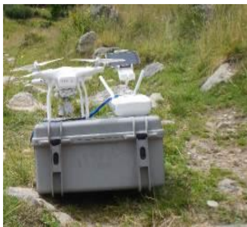
Figura nr. 5. Drona DJI Phantom III-Advanced pregătită de zbor (stânga); Dronă DJI Matrice 600 PRO cu unitate LiDAR
