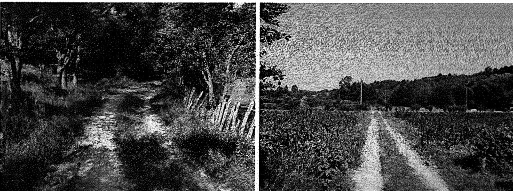
Drumul cu o lungime de 216m cu lățimea existenta de 2.50m, are partea carosabila din balast. În profil longitudinal declivitatea variază între 3.47 – 13.46% .
