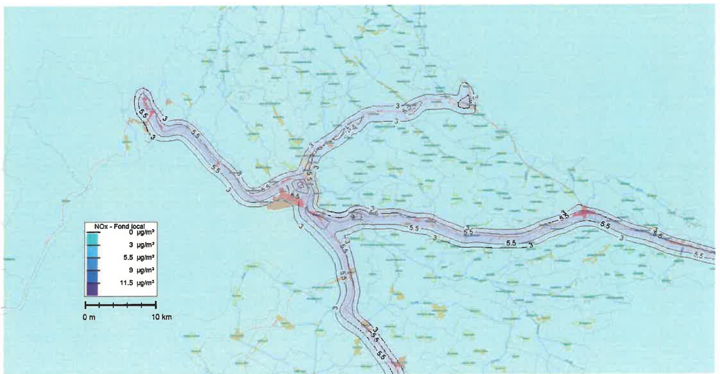
Anexa C.3.2.1.0 – Dispersia NOx în mediul rural din zona Mehedinți în anul de referință
