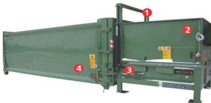
Figura 7-9 Sistem de compactare fix al deșeurilor
