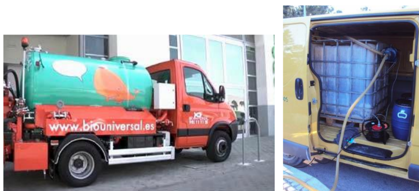
Figura 7-6 Tipuri de camioane și furgonete pentru transportul uleiurilor uzate din punctele de colectare
