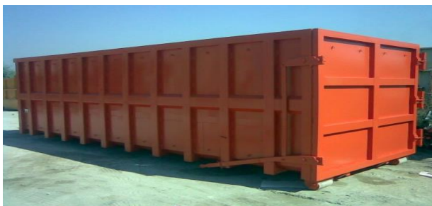
Figura 7-7 Containere de transport fără compactare
